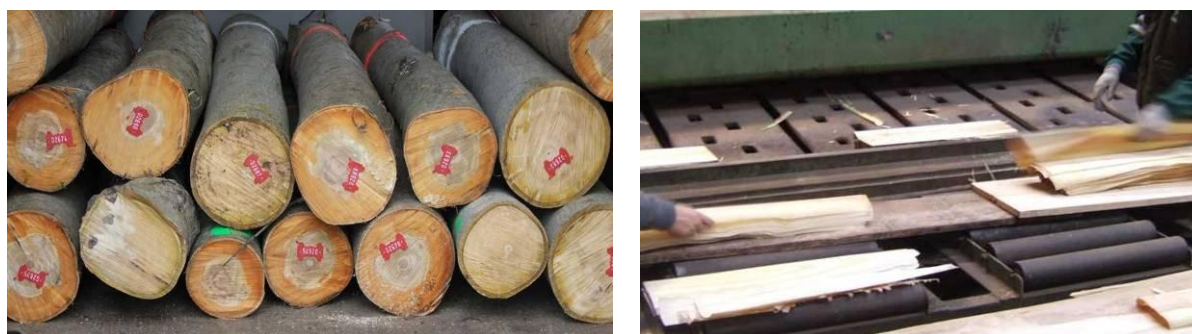
Figura 3. Imagen de trozas obtenidas y procesado de las mismas para obtención de chapa a la plana
