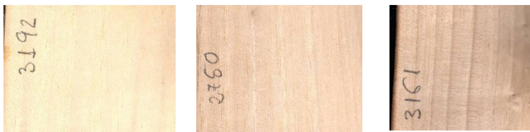
Figura 5. Muestra de los tres gradientes de tonalidad diferenciadas en las chapas de nogal y al mismo tiempo los tres niveles de marca de anillo caracterizados (para ambas variables de izda a derecha: 0,1,2)
