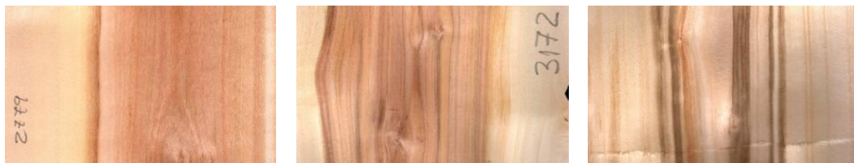
Figura 4. Muestra de los tres gradientes de presencia de vena verde diferenciados en la chapa de cerezo (de izda a dcha: 0,1,2)
