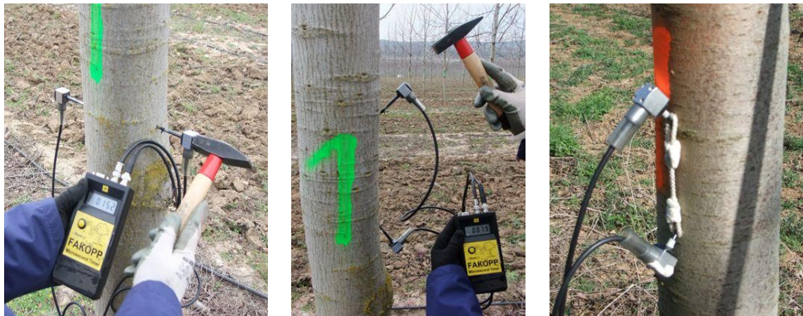
Figura 2. Metodología de medición transversal y longitudinal con los equipos Fakopp Microsecond Timer y Fakopp Ultrasonic Timer (de izda a derecha).
