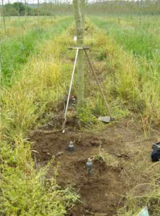
Figura 5. Unidad diagnóstica: tres sondas (30-60-90cm)
