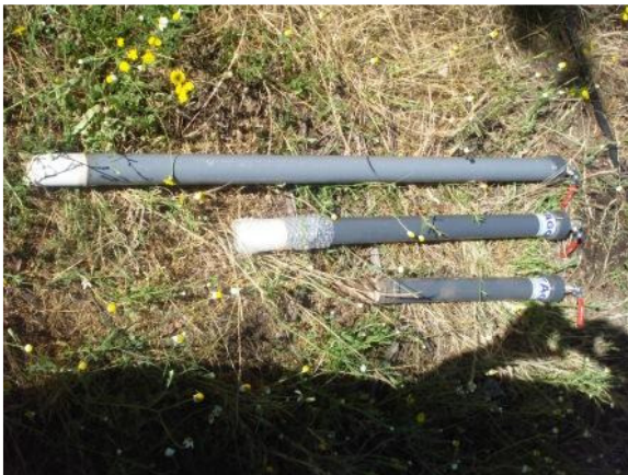
Figura 2. Sondas de 30, 60 y 90cm. de largo.
