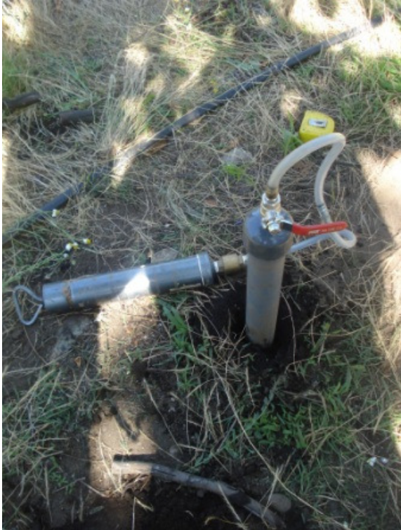
Figura 4. Sonda de succión y bomba de vacío.
