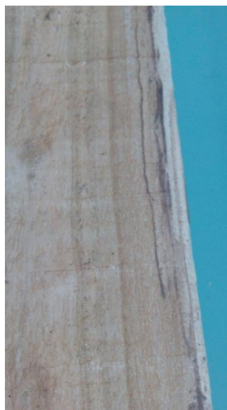
Figura 8. Línea oscura de delimitación de zona de ataque del hongo de pudrición blanca en su primera fase de degradación
