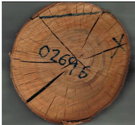
Figura 2: Fendas de secado que aparecen en las testas de las trozas por una pérdida muy rápida de humedad de la madera en sentido longitudinal a las fibras.
