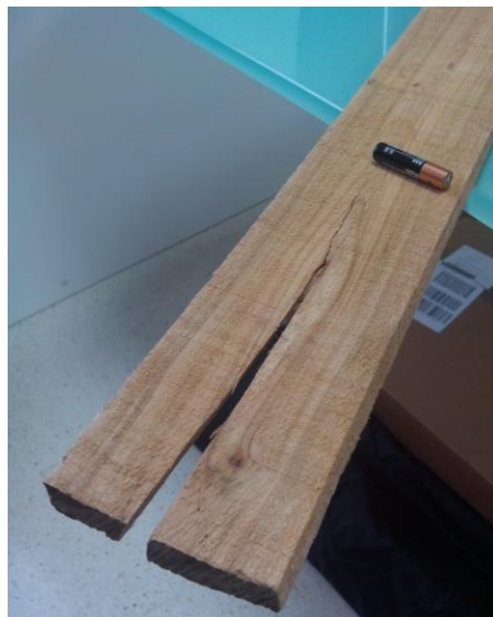
Figura 6: Fenda de cabeza en tabla de cerezo, posiblemente ocasionada por una pérdida muy rápida de humedad
