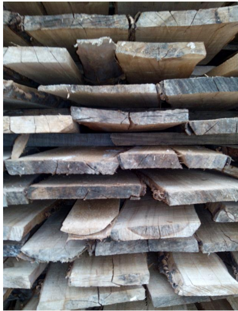
Figura 5: Aspecto de las cabezas de las tablas de cerezo secada al aire durante los meses de verano
