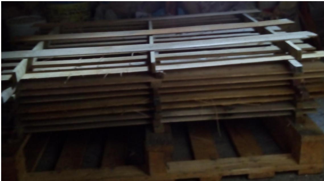
Figura12: ensayo de secado de madera al aire
