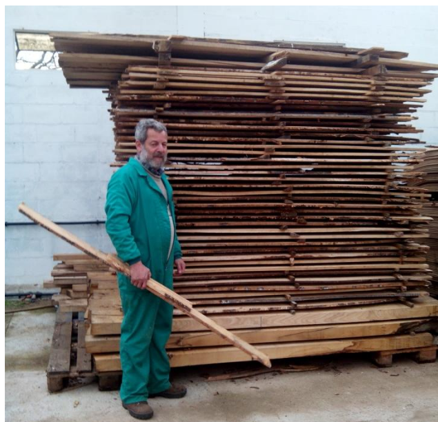
Figura 4: Aspecto de la pila de madera de cerezo aserrada y secada al aire
