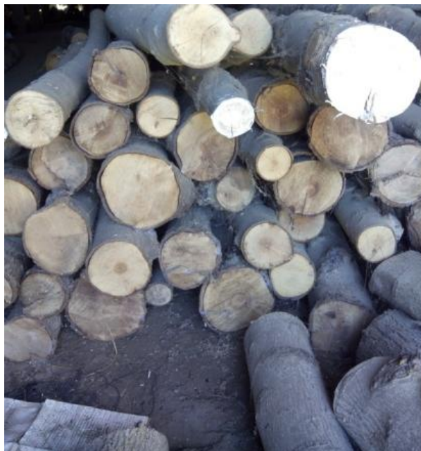
Figura 1: Aspecto general de la madera de nogal apilada directamente contra el suelo, impidiendo la correcta ventilación y circulación del aire y favoreciendo por tanto la aparición de hongos en las trozas en contacto con el suelo.
