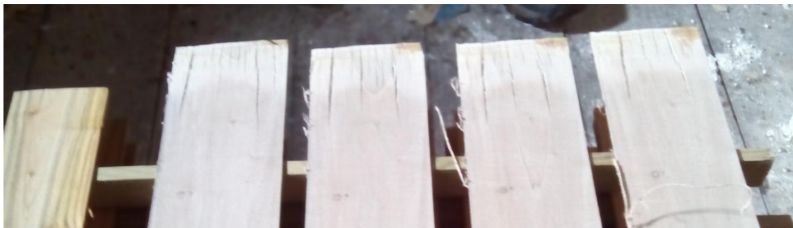
Figura 3: Repercusión en la tabla de nogal de las fendas de secado producidas en las testas de trozas. Las fenda provocan un desperdicio de unos 10 cm sobre la tabla
