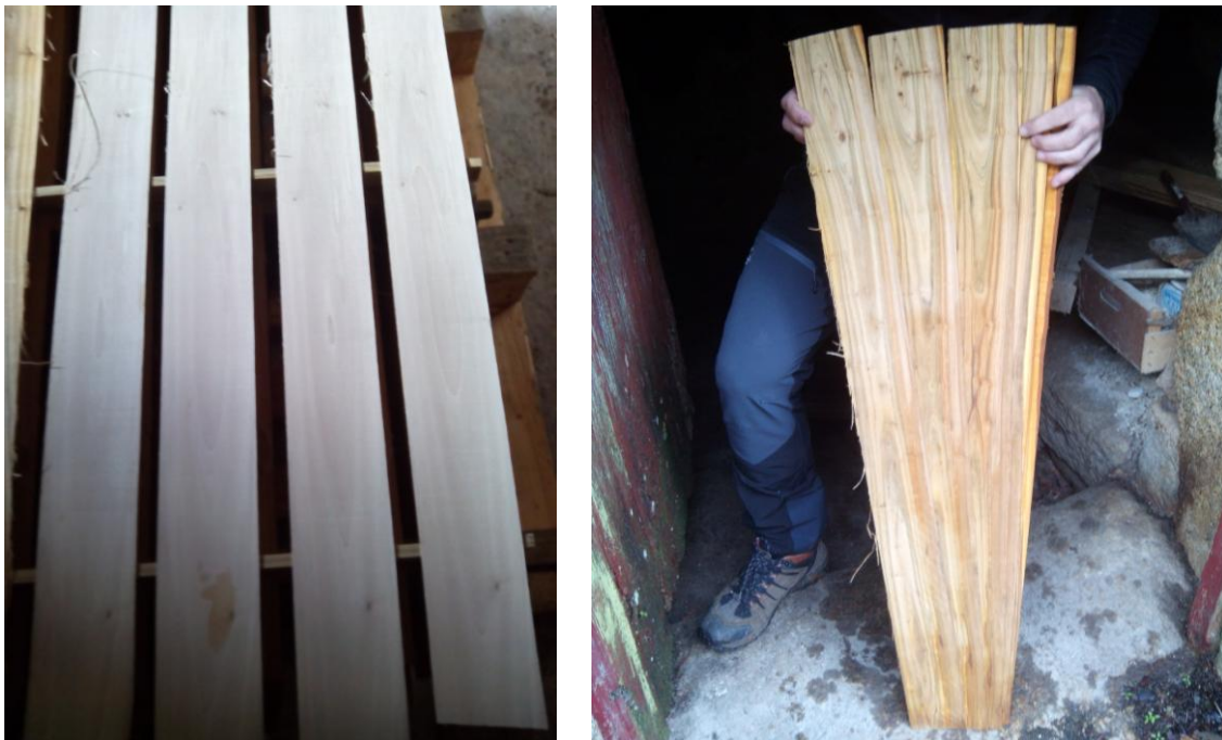
Figura 13: aspecto inicial de las tablas de sección 5mm de nogal y cerezo sobre las que se va a realizar el seguimiento del proceso de secado al aire.
