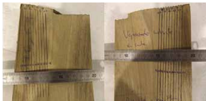
Pruebas de cortes con láser en madera de nogal seca en AIMEN
